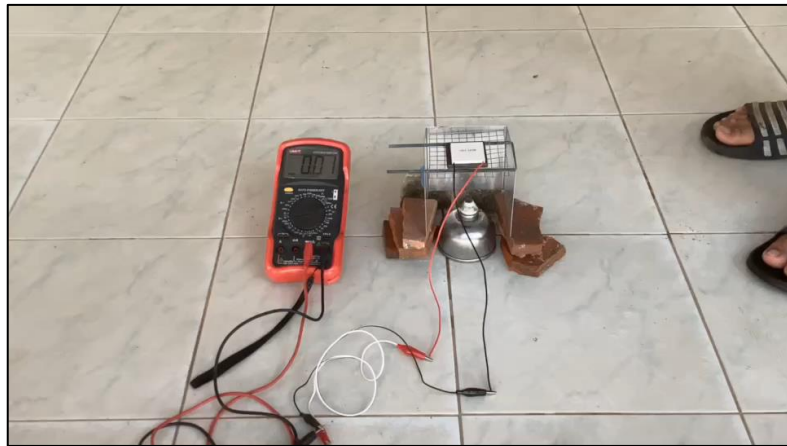
ทดลองหาวัสดุที่เหมาะสมเพื่อทำให้ความต่างศักย์ของอุณหภูมิมากที่สุดของเหล็ก
