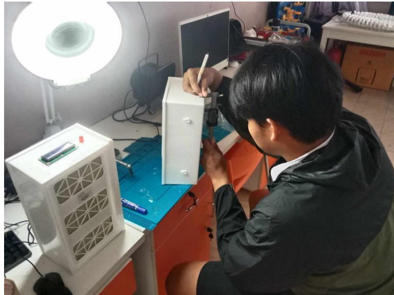
ภาพที่ 5 ขั้นตอนการวัดตู้รับชุดอุปกรณ์ เพื่อวัดขนาดรูสำหรับทางออกของสายไฟ
