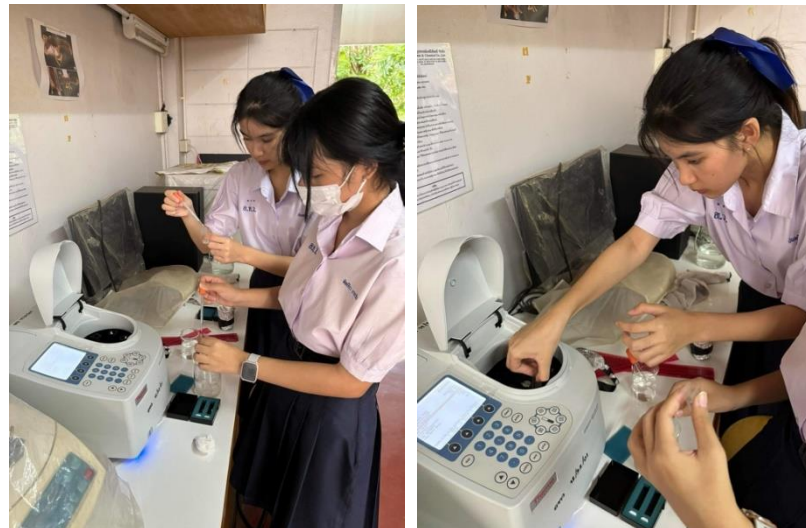
ภาพที่ 7 การตรวจสอบโพลีฟีนอลด้วยเครื่องสเปกโตรโฟโตมิเตอร์
