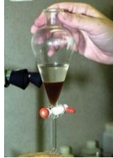
ภาพที่ 2.4 การสกัดแบบแช่โดยใช้กรวยแยกสาร
