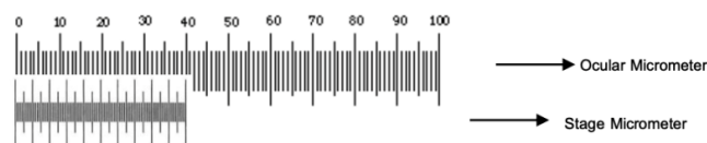
ภาพที่ 2.10 เทียบกำลังขยาย 40 เท่า Stage Micrometer กับ Ocular Micrometer ที่มา https://hiperc.sru.ac.th/pluginfile.php/18101/mod
