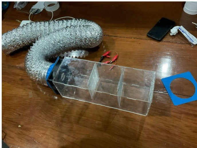
ภาพที่ 6 ประกอบแผ่นกรองเข้าตัวเครื่อง
