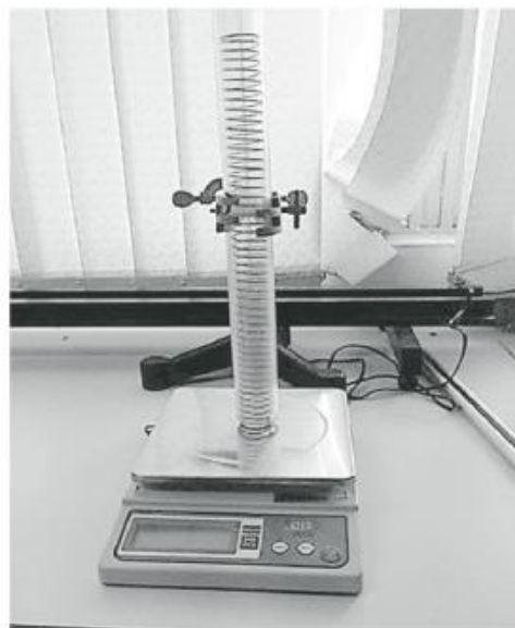
ภาพที่ 4 ทดลองหาค่านิจของสปริงโดยวิธีกดสปริง
